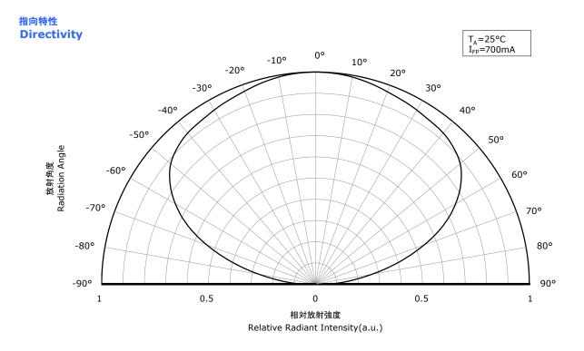
\* 本特性はピーク波長ランクU405xに対応しています。 The graphs above show the characteristics for U405x LEDs of this product.
