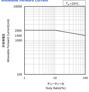
\* 本特性はピーク波長ランクU395xに対応しています。 The graphs above show the characteristics for U395x LEDs of this product.
