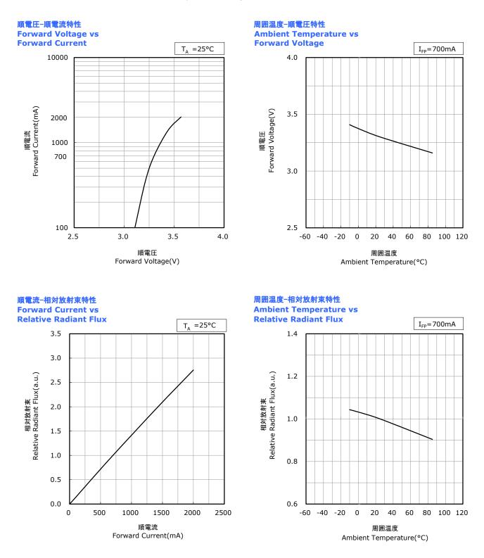
\* 本特性はピーク波長ランクU395xに対応しています。 The graphs above show the characteristics for U395x LEDs of this product.
