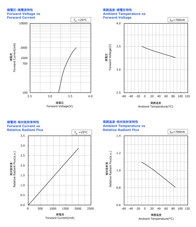
\*本特性はピーク波長ランクU375xに対応しています。 The graphs above show the characteristics for U375x LEDs of this product.
