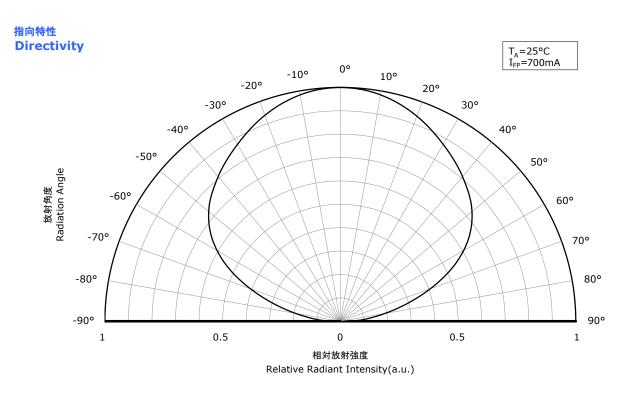
\* 本特性はピーク波長ランクU395xに対応しています。 The graphs above show the characteristics for U395x LEDs of this product.
