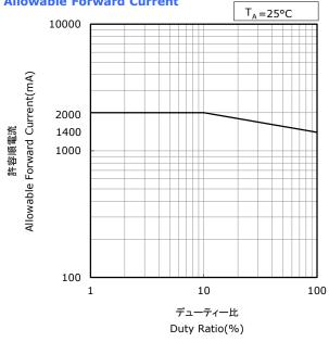
\*本特性はピーク波長ランクU385xに対応しています。 The graphs above show the characteristics for U385x LEDs of this product.
