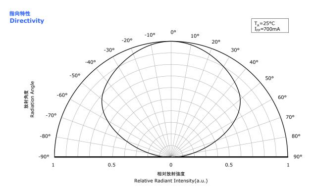
\* 本特性はピーク波長ランクU375xに対応しています。 The graphs above show the characteristics for U375x LEDs of this product.
