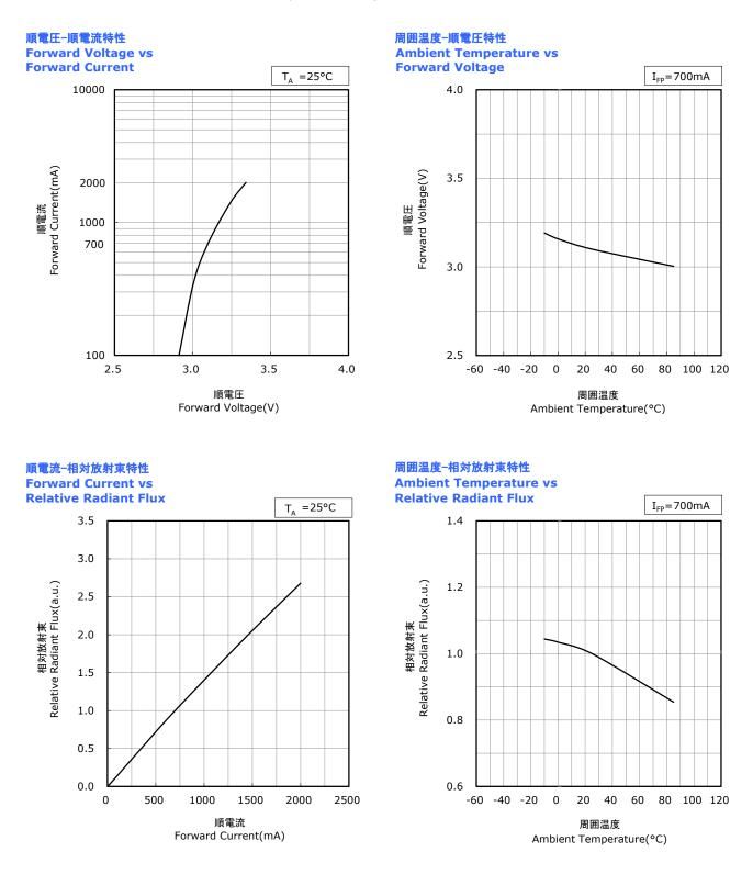
\* 本特性はピーク波長ランクU405xに対応しています。 The graphs above show the characteristics for U405x LEDs of this product.
