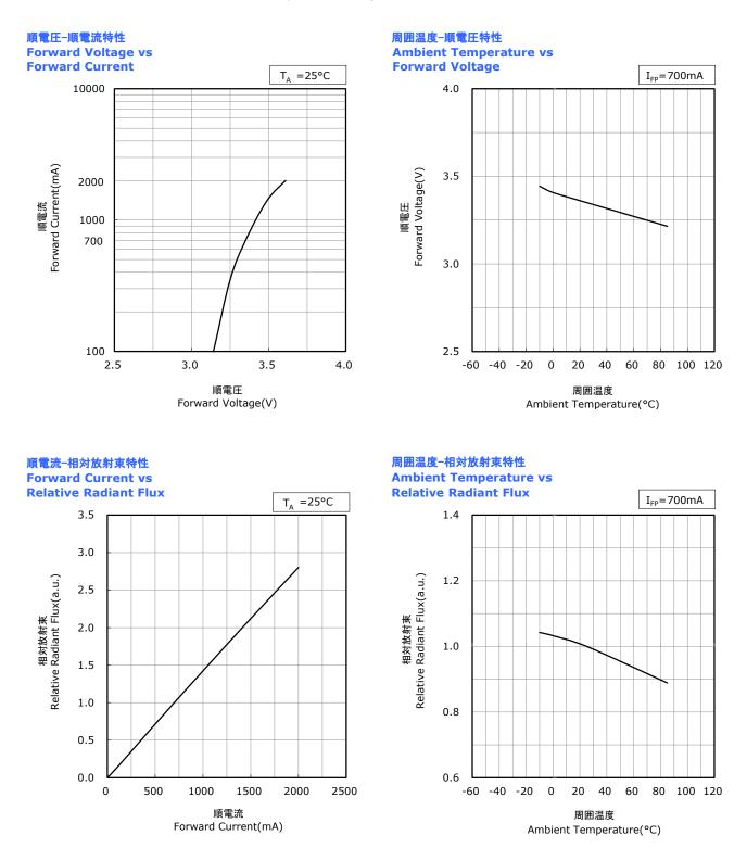
\* 本特性はピーク波長ランクU385xに対応しています。 The graphs above show the characteristics for U385x LEDs of this product.
