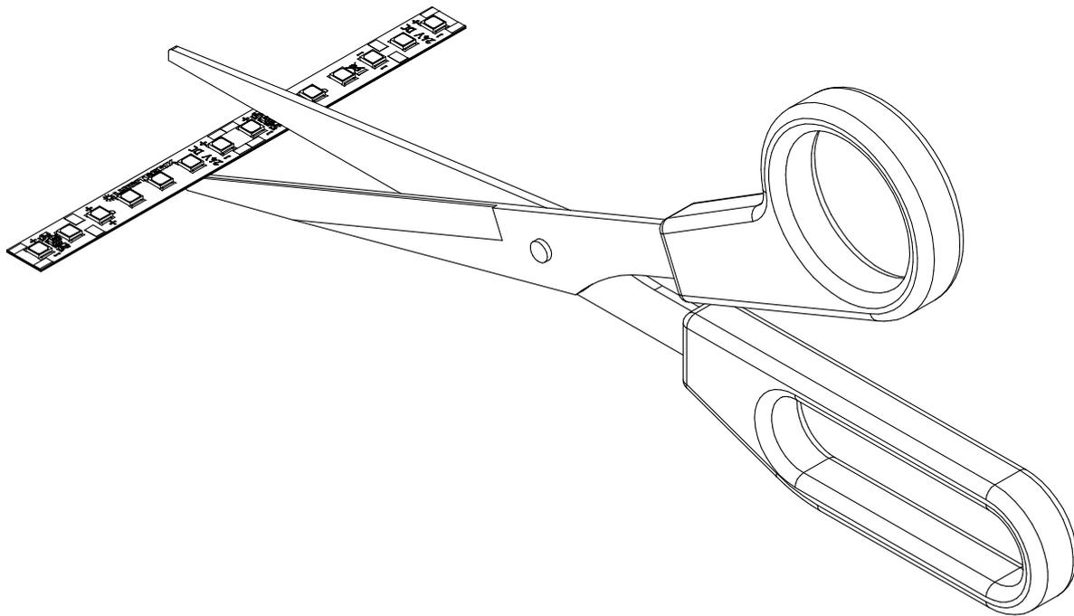
Die Z-Flex 280 x 20 LED-Module können alle 280 mm getrennt bzw. gekürzt werden. Auf der Rückseite des LED-Moduls befindet sich ein doppelseitiges wärmeleitendes Klebeband, wodurch eine einfache und schnelle Montage des LED-Moduls möglich ist. Dadurch können Sie nahezu alle Flächen und Formen direkt oder indirekt beleuchten. Zum Kürzen der Z-Flex 280 x 20 LED-Module kann eine Schere verwendet werden.
