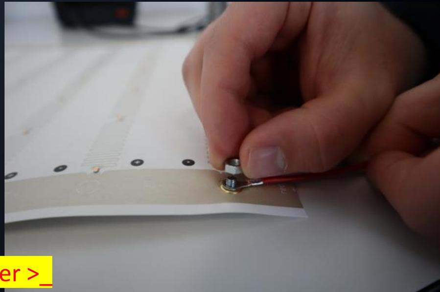
Kabel 0,5 mm<sup>2</sup> an Öse löten
